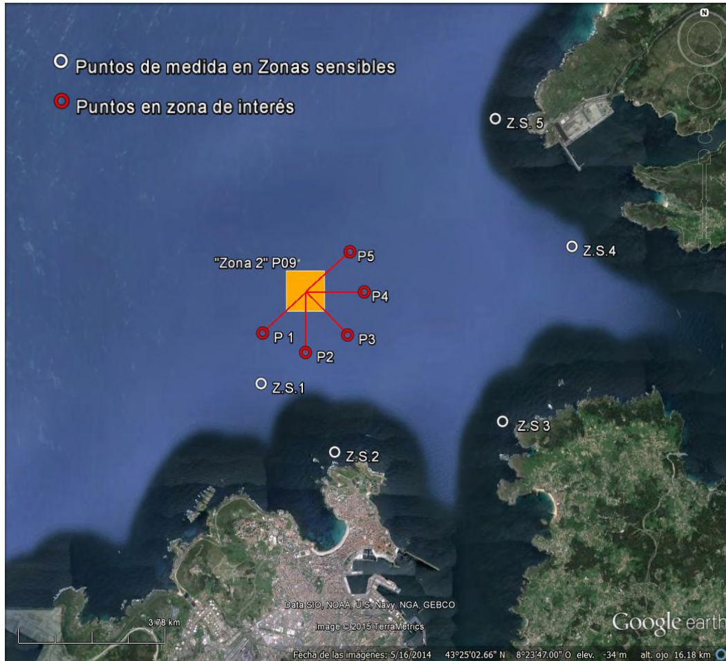
Figura 7.1.1.- Puntos de control del PVA de la zona de vertido
